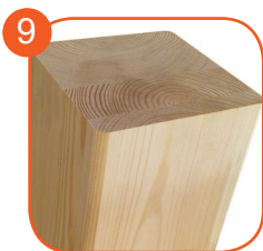
9 Měkké smrkové dřevo 140 x 140 mm, bez jádra, bez suků, lepené po vrstvách polyuretanovými lepidly, zcela odolné vůči vodě. Dřevo je ošetřené proti povětrnostním vlivům dvojitou ochrannou impregnací.
