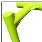
Pevná konstrukce z černé oceli S235JR, čištěná pískováním. Chráněno proti korozi pozinkováním a práškovým lakováním polyesterovou barvou QUALICOAT s atestem.
